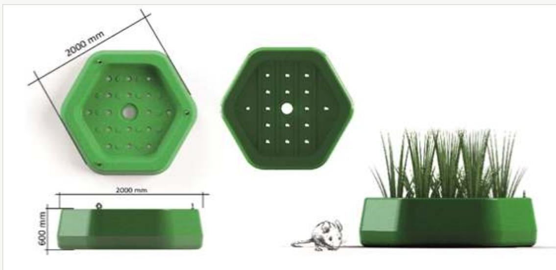
**Figura 2** Esquema de isla flotante.
